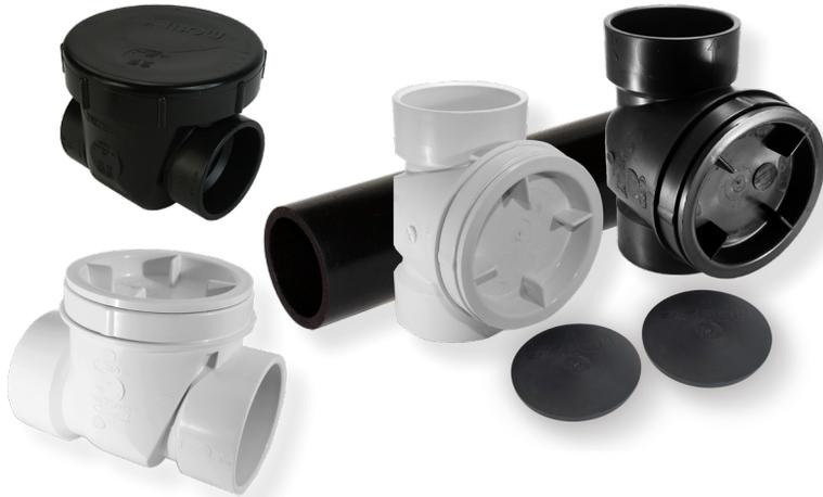
Les soupapes de retenue doivent être installées sur un système de drainage de bâtiment lorsqu'il y a possibilité d'inondation dû à un refoulement, un bris ou une surcharge égout. Les appareils de drainage situés au plancher inférieur soit: la cuve à lavage, le lave vaisselle et le drain de plancher, doivent être protégés du refoulement des eaux usées à l'aide de modèles compacts de 1-1/2 po. et 2 po.
